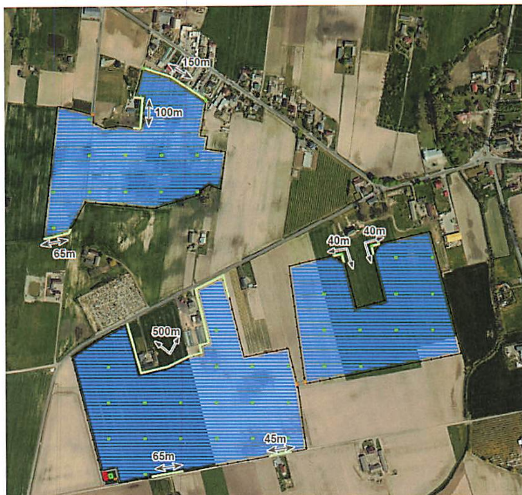
Rysunek 1. Plan nasadzeń zieleni izolacyjnej (zielone linie), zgodnie z raportem o oddziaływaniu przedsięwzięcia na środowisko wraz z uzupełnieniami.
